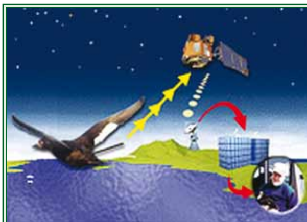
Figura 14. Esquema de funcionamento da emissão de um sinal e a recepção e análise de dados. - Sistema Argos
